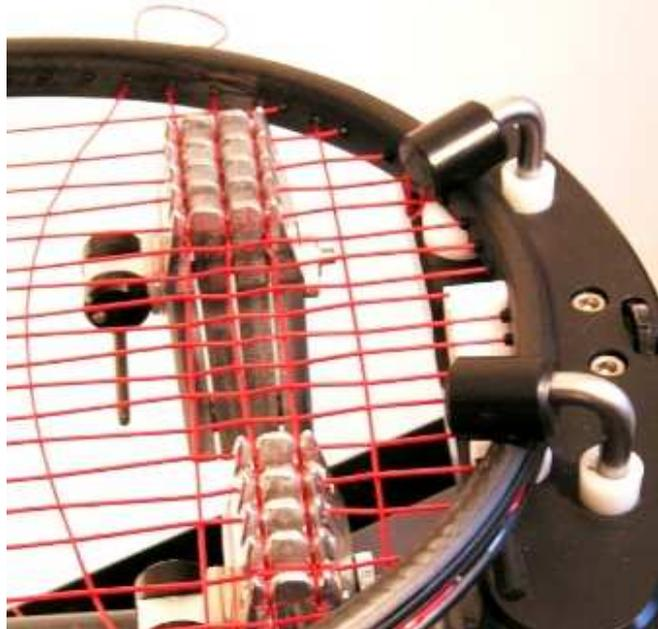
6. Entrelacer T3 et T4 > baisser la tension de -2kgs sur T3 et bloquer la DP T3+T2. C'est plus facile d'installer un travers en amont avant de tendre le précédent, donc > T5 avant de tendre T4. Desserrer la molette de la TP pour bloquer 3 cordes T2+T3+T4. Ces 4 travers sont en place. (photo n°6)
