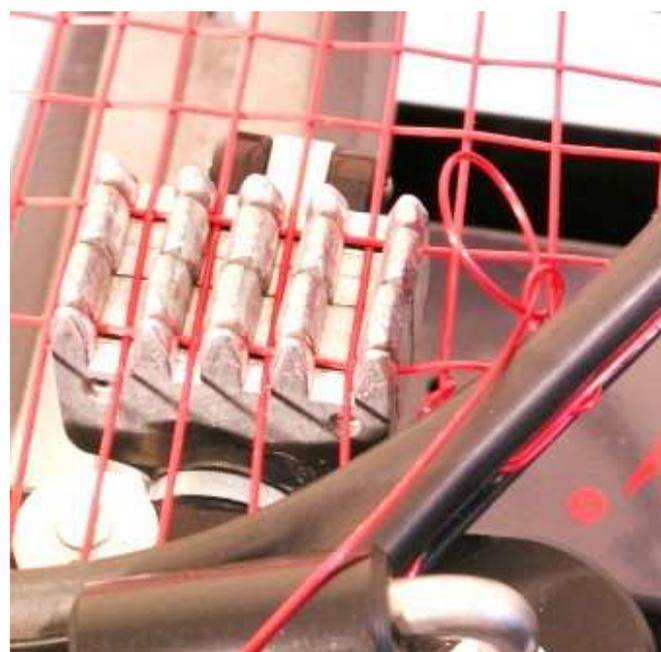
8. Tendre le dernier travers T19 > bloquer la TP T18+T19. Faire le nœud sur D7. (photo 8) **Travers terminés**, il ne reste qu'à « aligner » les cordes et de retirer le cadre du plateau.
