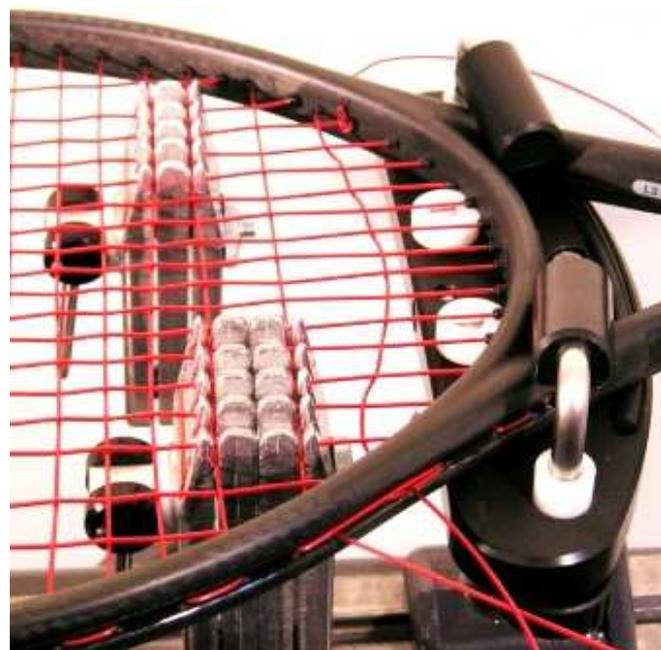
7. De T2 à T17 il y a un faible écartement des travers et les DP (2 cordes) et TP (3 cordes) sont bien adaptées. L'espace entre T17-T18 et T18-T19 est de 20mm, trop large pour le DP, mais parfait pour le TP si réglée en mode XL (2 cordes). Voici T18 tendu à +4kgs, bloquer la TP T17+T18. (photo n°7)
